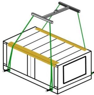
Werden kein Abstandsgeschirr oder Querriegel verwendet kommt es zu Beschädigungen an den Gerätegehäusen und Paneelen.
